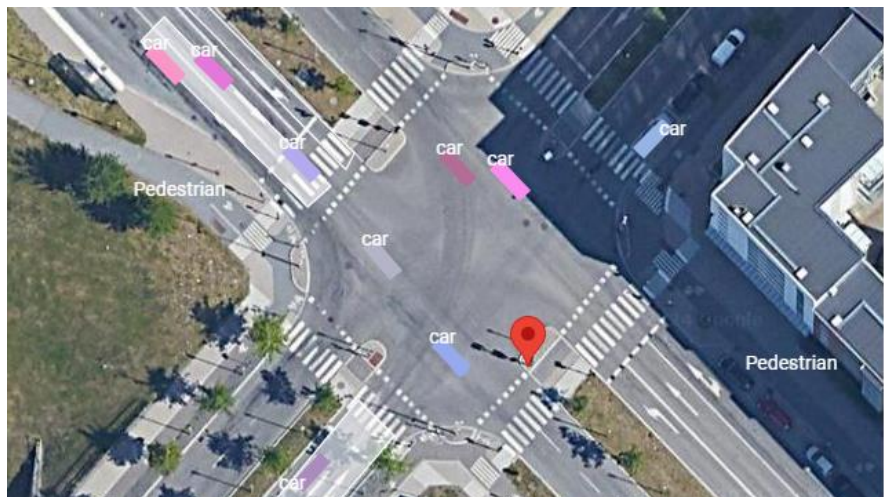
Figur 36 Test med lidarmätningar i korsningen Hanstavägen/Norgegatan med hjälp av AI (maskininlärning). Källa: Trafikkontoret.
