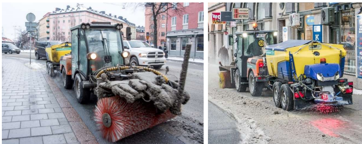
Figur 16. Den utrustning som användes för sopsaltning av gångbanan längs S:t Eriksgatan.
