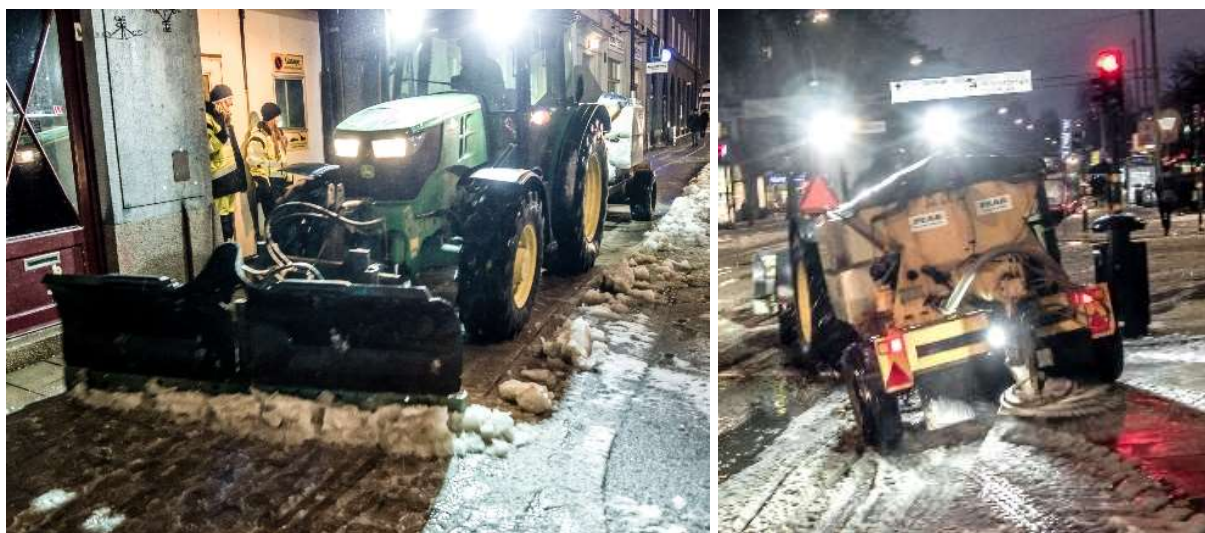
Figur 15. Den utrustning som använts vid snöröjning och saltning på trottoaren längs Sveavägen.
