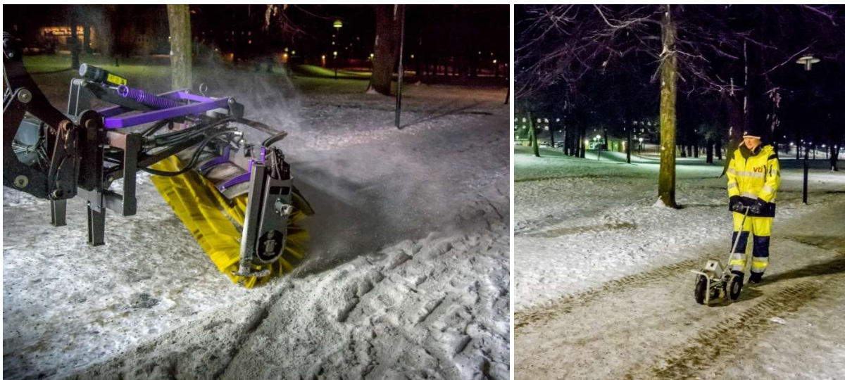
Figur 5. Borstning av den snötäckta gångbanan inför försöken med olika typer av salter (till vänster) med efterföljande friktionsmätning (till höger), vid 6-tiden på morgonen den 22 januari 2018.
