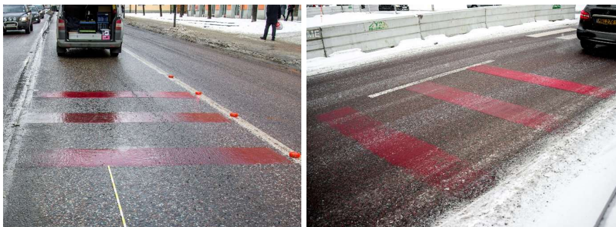
Figur 35. De tre fälten med olika typer av rödfärgade massor på Fleminggatan (till vänster) respektive vid infarten till cirkulationen vid Bergslagsplan (till höger), den 7 mars 2018.
