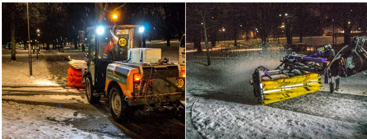
Figur 12. De två olika borstar som jämfördes i samband med försöken av olika halkbekämpningsmedel: "Svischen" till höger och den mjukare och tätare borsten till vänster.
