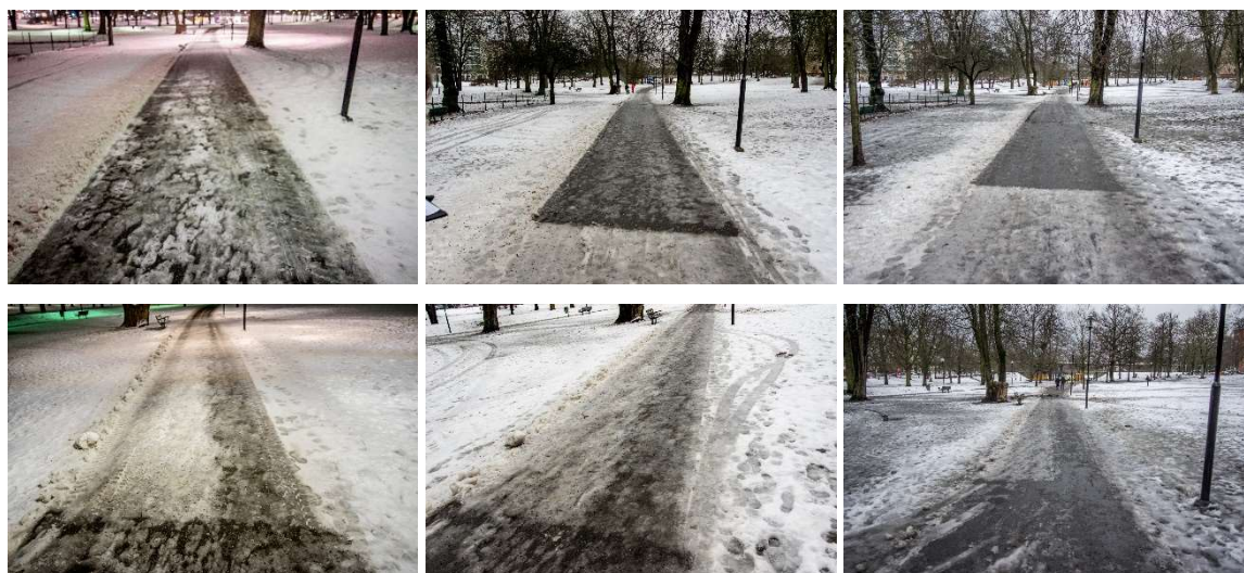
Figur 13. De borstade ytorna 2018-01-24 ca kl 06.35, 10.45 och 15.25. Övre raden "Svischen" och nedre raden den mjuka borsten.
