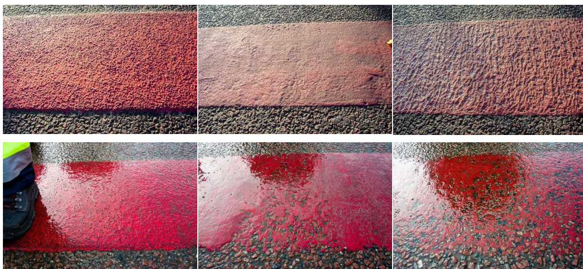
Figur 37. De tre olika färgmassorna vid infarten till cirkulationen vid Bergslagsplan: Bauxit längst till vänster, Slät tysk massa i mitten och EKC:s vanliga rollade röda massa längst till höger. Den övre bildraden visar ytorna innan vintern (den 16 november) medan den nedre bildraden visar ytorna efter vintersäsongen (den 7 mars). Fotona visar ytorna i hjulspåret ca 1 meter in från ytterkanten av de målade ytorna där vi antagit att slitaget är som störst.
