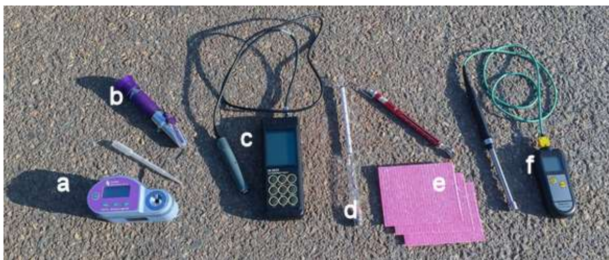
Figur 39. Rekommenderat "salt-kit" för utförarnas egen uppföljning av sopsaltmetoden: a) digital refraktometer med tillhörande pipett för att mäta saltkoncentrationen i vätska (till exempel prov från vägytan eller saltkoncentrationen i tanken), b) manuell refraktometer (som a, men behöver kalibreras utifrån vätskans temperatur), c) konduktivitetsmätare för saltkoncentration i tanken, d) densitetsgivare för saltkoncentration i tanken, e) wettexdukar och fjädervåg för att mäta vätskemängden på ytan och f) termometer för att mäta vägytans temperatur. Minsta rekommendation är att åtminstone ha en yttertermometer (f) och någon av a–d, för att säkerställa saltlösningens koncentration.
