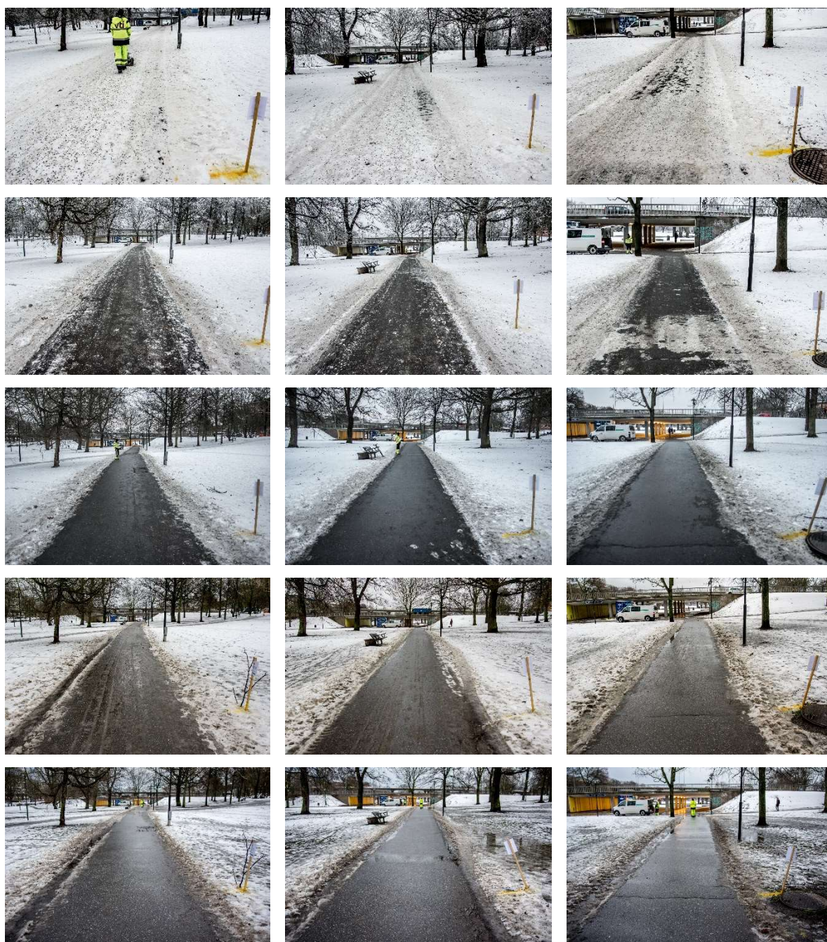
Figur 10. Förändring av väglaget på de olika teststräckorna under försökets gång. Från vänster till höger de tre delsträckorna för Kaliumformiat, Karlstadslake och Natriumklorid. Uppifrån och ned: 2018-01-22 kl 11.10, 2018-01-22 kl 15.40, 2018-01-23 kl 10.45, 2018-01-24 kl 10.50, 2018-01-24 kl 15.25.
