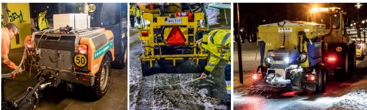
Figur 6. De olika spridare som användes vid försöket: 1) för spridning av Kaliumformiat; 2) för spridning av Karlstadslaken; 3) för spridning av \text{NaCl} -lösning.
