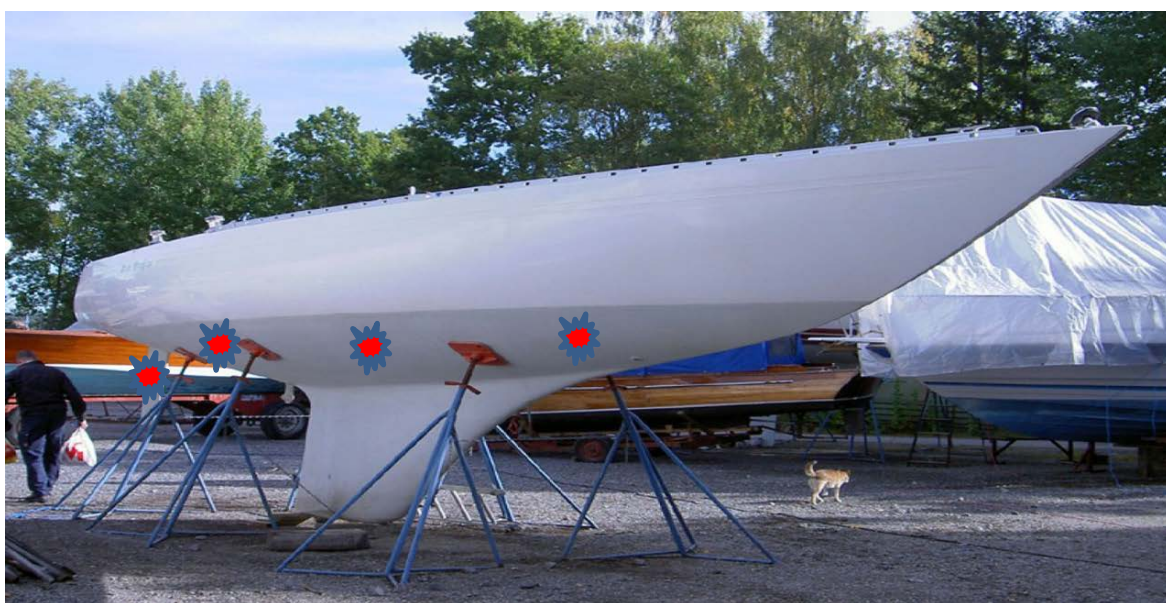
Figur 1. Mätpunkter på båtar mätta av Happy Boat AB. Mätningar utfördes 10-30 cm nedanför vattenlinjen på både styrbord och babord sida enligt bilden (styrbord bak, styrbord mitt, styrbord för, babord för, babord mitt och babord bak plus ömse sidor av rodret). På motorbåtar utan roder mättes på akterspegeln eller drevstocken/skäddan.
